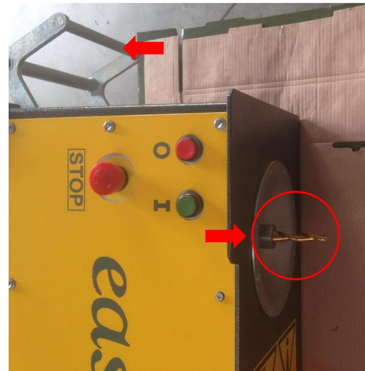
**SCHRITT 3:** Zum Bohrerwechsel nun die zwei am Bohrfutter befindlichen Madenschrauben lösen, Bohrer herausziehen und durch neuen Bohrer ersetzen. Ggf. etwas Kriech- oder Multifunktionsöl vor einführen des neuen Bohrers in das Bohrfutter geben (abgeflachte Seite in Richtung der Madenschrauben) um ein festsitzen zu verhindern. Nach einführen des neuen Bohrers Madenschrauben wieder festziehen.
