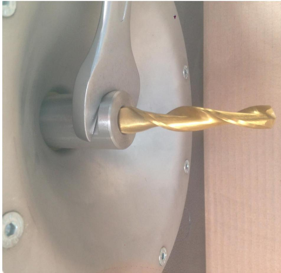
**SCHRITT 6:** Im Falle eines abgebrochenen oder sich nicht aus dem Bohrfutter lösenden Bohrers nun an der unten liegenden Gewindeseite (Innengewinde) ein Gewinde der Größe M14 einschrauben. Bohrer dazu ggf. einspannen. Durch das einschrauben wird der Bohrer dann nach oben herausgedrückt.
