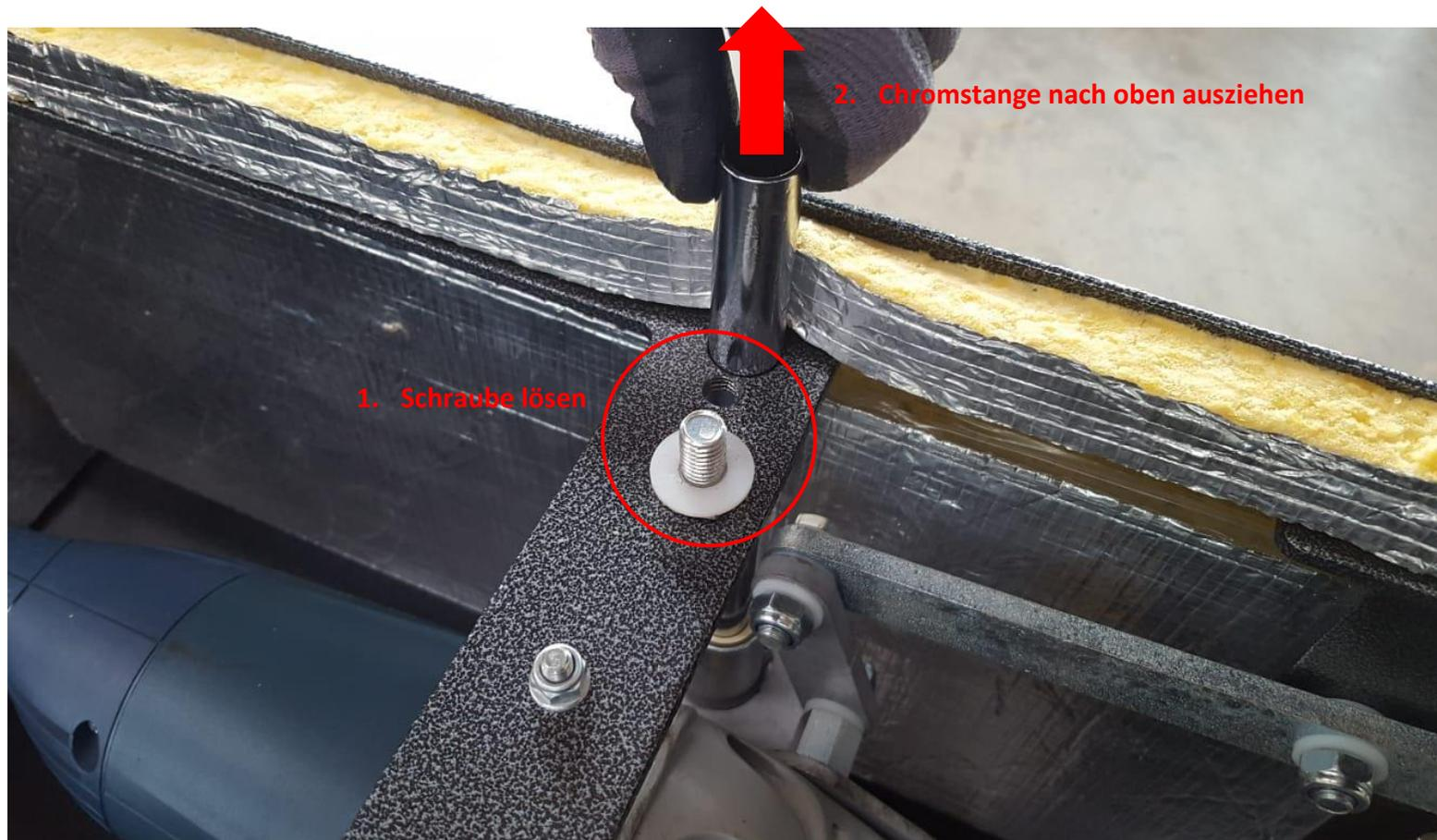
**SCHRITT 7:** Durchmesser der Chromstange auf einer Länge von ca. 3,5 cm durch abschleifen minimal verringern. Anschließend wieder einsetzen und nun auch diese auf ein minimales Spiel in der „Fassung“ überprüfen. Schraube zur Fixierung der Chromstange wieder festziehen, Maschine umdrehen und erneut prüfen. Sollte dies immer noch keine Wirkung zeigen, Vorgang auch bei der zweiten Chromstange wiederholen.
