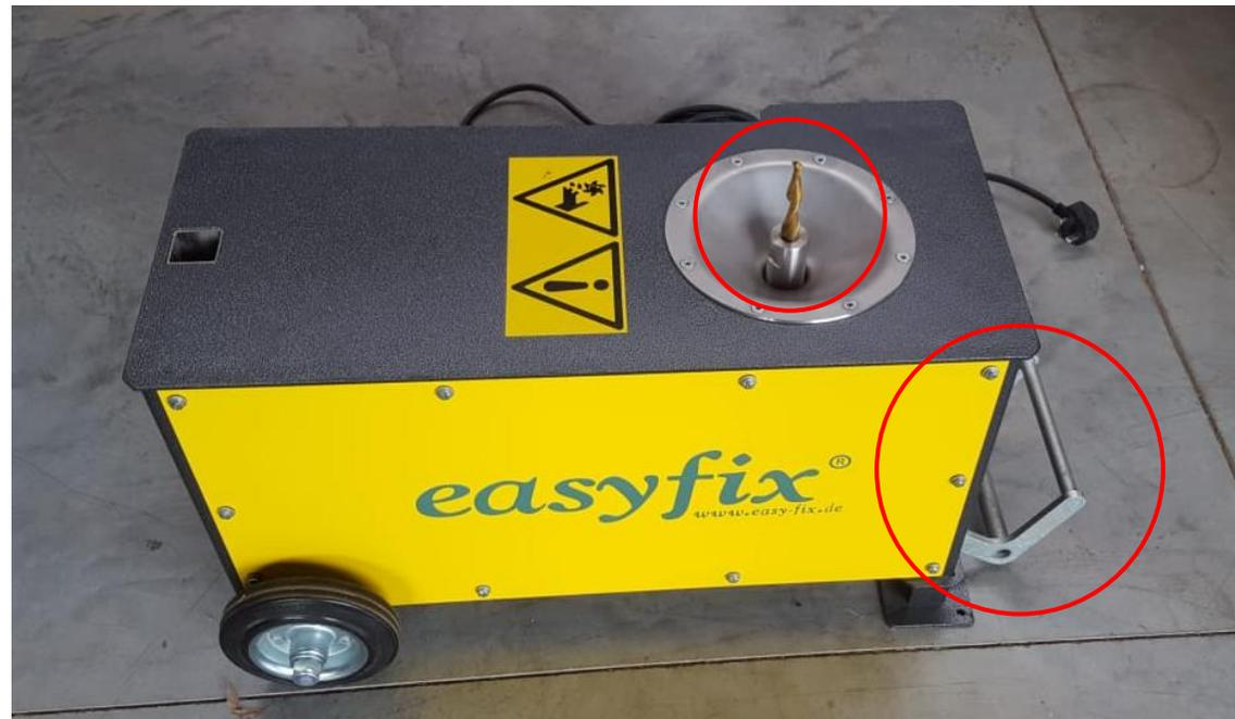
**Auswirkung:** Nach dem Bohrvorgang verbleibt der Bohrer im Stammende. Beim Herunternehmen des Baumes von der Maschine wirken so, je nach Baumhöhe, extreme Hebelkräfte auf den Bohrer, so dass dieser schnell abbrechen kann.
